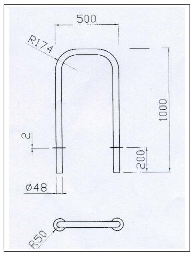
Archetto stradale antisosta, fisso con rondelle coprispacco Realizzato in acciaio inox aisi304
